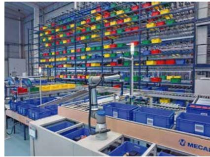
realizar tareas que antes se limitaban a la intervención manual. UR20 de Universal Robots, con su alcance extendido y diseño compacto, que permite la automatización de aplicaciones que requieren el levantamiento de objetos pesados en distancias más largas, manteniendo al mismo tiempo los estándares de seguridad de UR (la solución funciona a la perfección en toda la familia de cobots UR).
