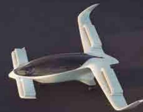
Se trata del sistema de sujeción del motor o «flap», estructura de la parte trasera de las alas y canard, uno de los componentes clave del Lilium Jet que proporciona sustentación al interactuar con el flujo de aire del motor. También alberga los sistemas de propulsión vectorial, responsables del vuelo vertical y horizontal.
